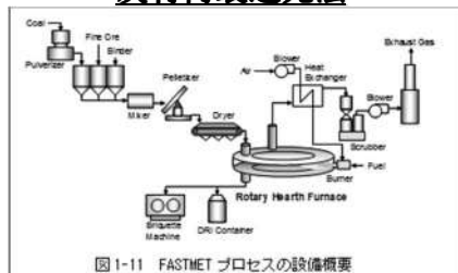
図 1-11 FASTMET プロセスの設備概要
