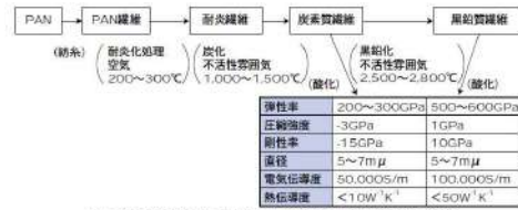
図1 炭素繊維の製造プロセスと炭素質と黒鉛質繊維の諸性質
