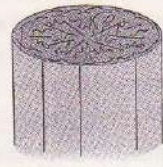
図5.31 PAN 繊維の典型的な断面構造
